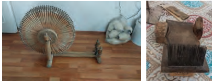
Fotoğraf: 5. a) Çıkırıktaki ve bobine sarılmış tiftik ipliği, b) Tiftik tarağı, (İbrahim Yeniçeri'nin evi, Ankara, Soysaldı-Aydın, 2023).
