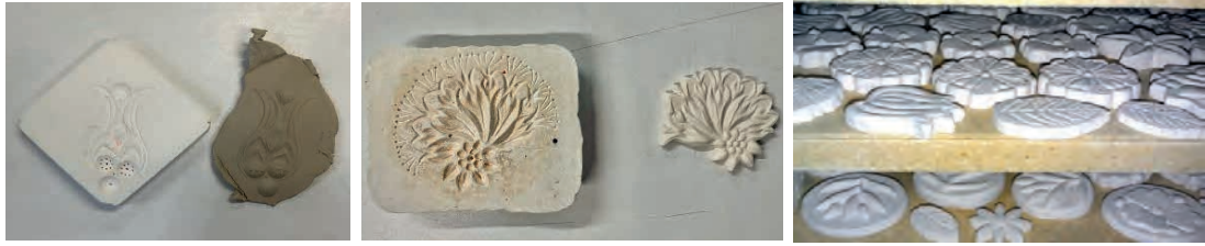
Fotoğraf: 19-20-21. Alçı Kalıp, basılmış çamur. Alçı Kalıp, pahlanmış katman. Katmanların bisküvi pişirimi
