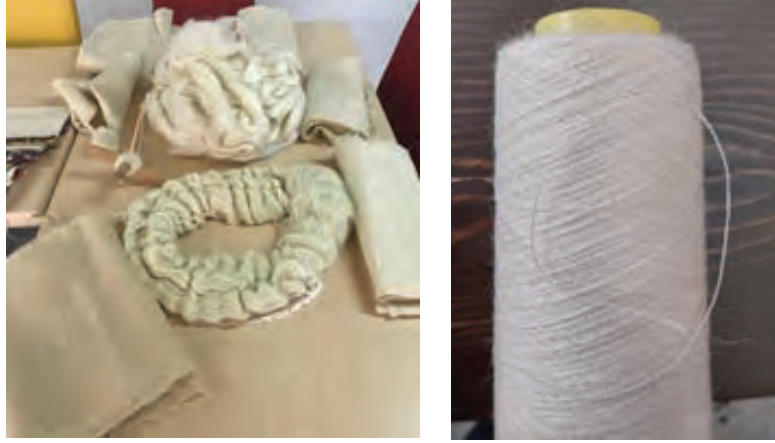
Fotoğraf: 9. a) Tiftik tops, elde eğrilmiş iplik çilesi, çift katlı tiftik ipliği bobini, (Proje ekibi, Nisan 2022)
