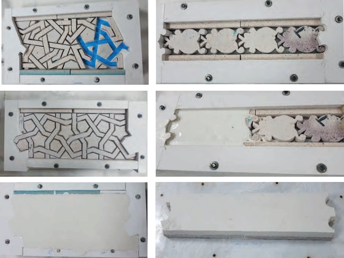
Fotoğraf: 16. Özel hazırlanan kalıplara çini parçaların tersten yerleştirilip sıvı halde alçı-kireç karışımı harç dökülmesi
